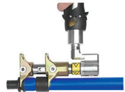
4 : اتمام عملیات اتصال با حرکت حلقه
